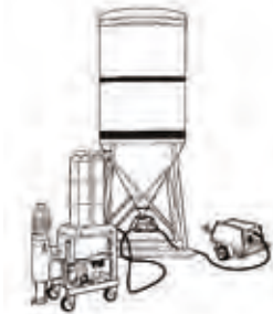
maxit Trockenmörtelsilo als Freifallsilo oder Drucksilo zur Montage der kundeneigenen Putzmaschine
