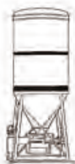
maxit Trockenmörtelsilo mit angebauter, betriebsbereiter Silomischpumpe [SMP-FB] zum vollautomatischen Anmischen und Pumpen von Mauermörtel- und Betonprodukten
